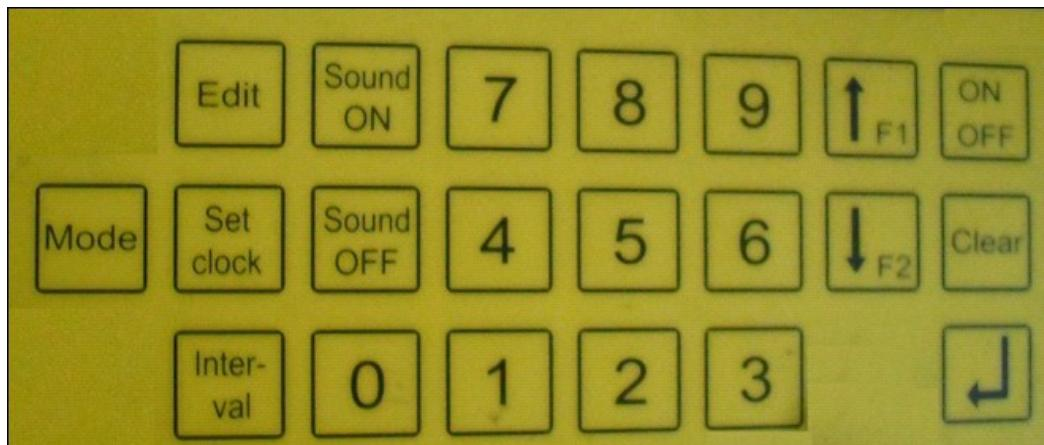
Kun de tastene som har en funksjon i aktuelt modus er mulig å trykke på. Dvs at hvis ingenting skjer når man trykker en tast, er det fordi tasten er deaktivert.
