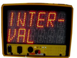
Løpende tid (hh:mm:ss) vises på øverste linje, startnr. og nedtelling av sekunder vises på nederste linje. Bruker starttiden og startintervallet som er lagt inn manuelt for å beregne startnr. NB! Startnr. 1 starter alltid på starttiden til arrangementet **PLUS** ett intervall (f.eks. 10:00:00 + 15 sek = 10:00:15)
